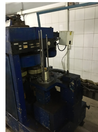
Рисунок 2 – Закатка жестяных банок № 1 автоматической закаточной машиной на ТОО «Семипалатинский мясоконсервный комбинат» ВКО
