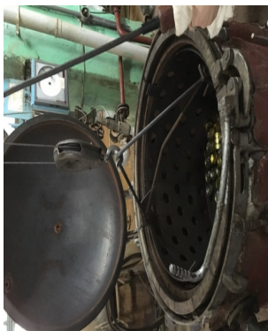
Рисунок 3 – Стерилизация консервов мясных паштетов в автоклаве на ТОО «Семипалатинский мясоконсервный комбинат»
